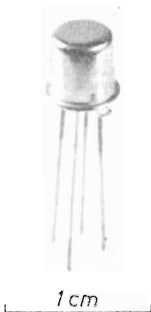
Fig. 13 - Il medesimo transistoro di figura 10 pronto per l'impiego.
