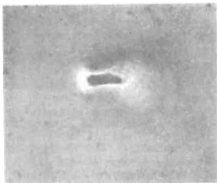
Fig. 6 - Fotografia di una puntina ellittica di forma non corretta, ottenuta usando il metodo di fig. 3.
